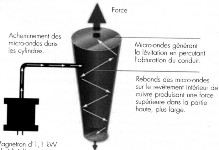
Magnétron d'1,1 kW refroidi à l'eau, générateur de micro-ondes.
