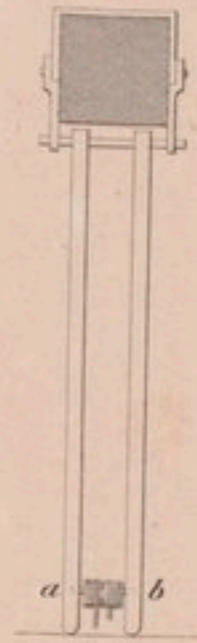
Coupe suivant l'axe des épointilles mobiles.
