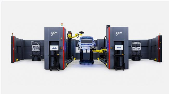
Une station d'inspection automatisée conçue par GOM.
