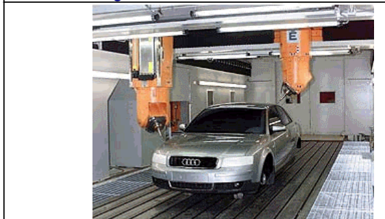
Double tête de fraisage pour usiner les maquettes de voiture en résine
