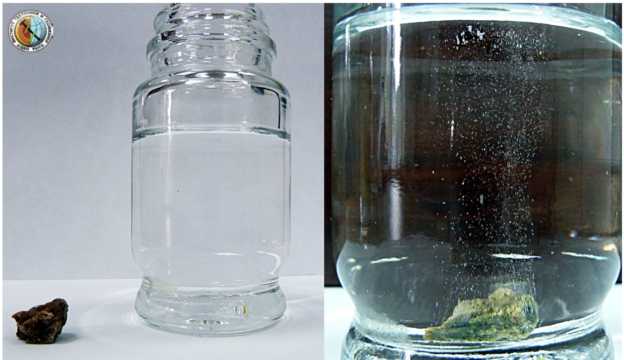
Photo d'une expérience sur la décomposition du calcaire, prise à partir des blocs des murs de la forteresse de Saqsaywaman, interagissant avec de l'acide acétique à 70 %.
