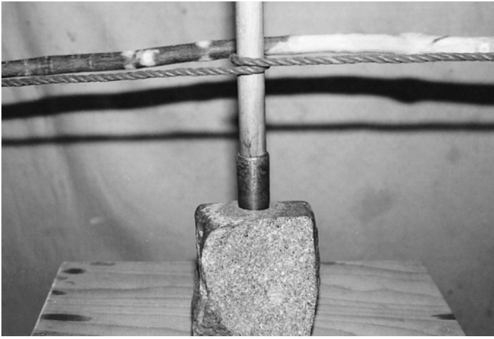
Figure 4.8 Forage de la diorite avec un tube en bronze entraîné par arc et un sable abrasif
