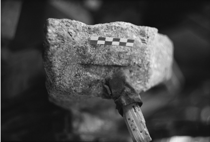
Illustration 3.16 Polissage du granit avec un tour de cuir et de la boue
