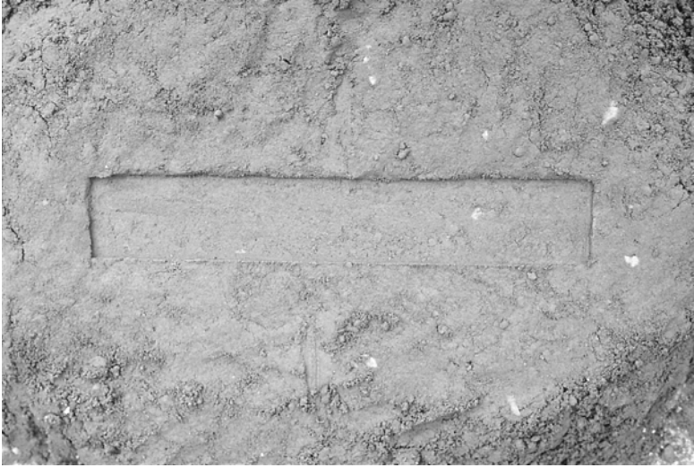
Illustration 2.14 Un moule pressé dans du sable humide pour couler une scie à lame plate
