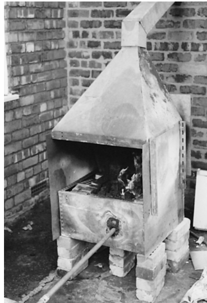
Illustration 2.48 Le four de l'auteur pour fondre le cuivre et le bronze
