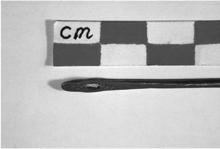
Illustration 2.37 Un trou percé dans la tête d'une aiguille en cuivre recuit
