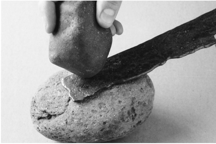
Illustration 2.28 Batre un moulage de scie en cuivre reconstruit pour façonner sur une enclume de pierre avec un marteau de pierre
