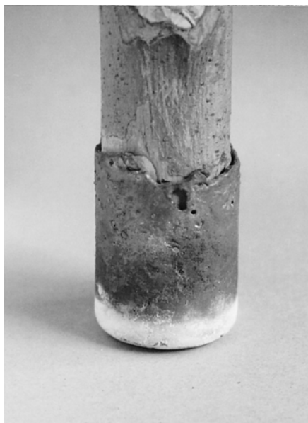
Figure 5.18 Un tube de forage en cuivre coulé de 7 cm de diamètre, monté à l'extrémité inférieure d'un puits central TRTD
