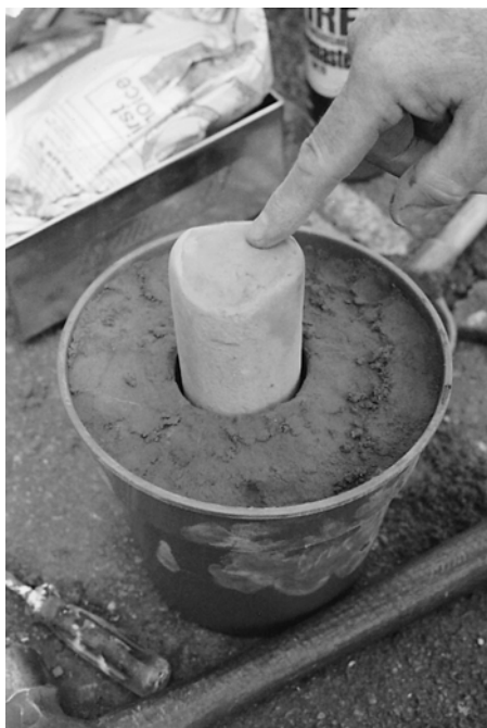
Figure 4.4 Un moule de forme tubulaire en sable, prêt à être rempli de cuivre fondu
