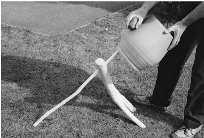
Illustration 2.32 Démonstration de l'enclume tripode, ajustée pour une utilisation avec un grand navire
