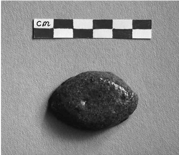
Illustration 9.4 Un échantillon de glaçure, fabriqué à partir de la poudre dérivée du granit
