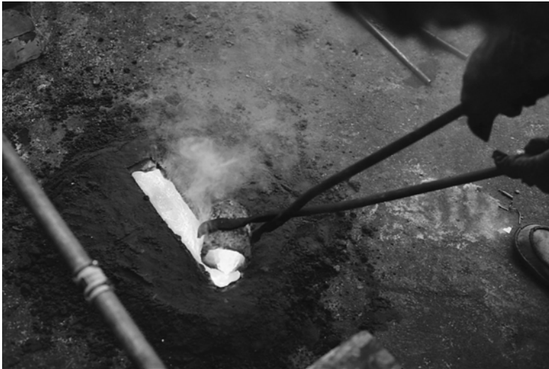
Illustration 2.15 Moulage d'une lame de scie en cuivre à tranchant plat dans un moule à sable ouvert
