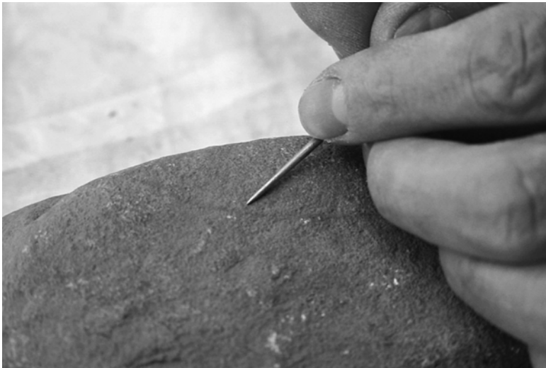
Illustration 2.38 Aiguiser la pointe d'une aiguille trempée au marteau sur un morceau de grès
