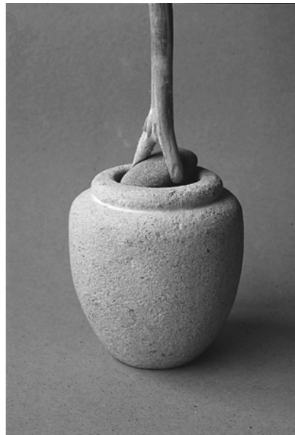
Figure 5.36 La perceuse en forme de huit engagée dans la rainure
