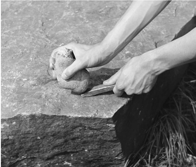
Figure 2.50 Marteler une coulée de bronze dans un ciseau
