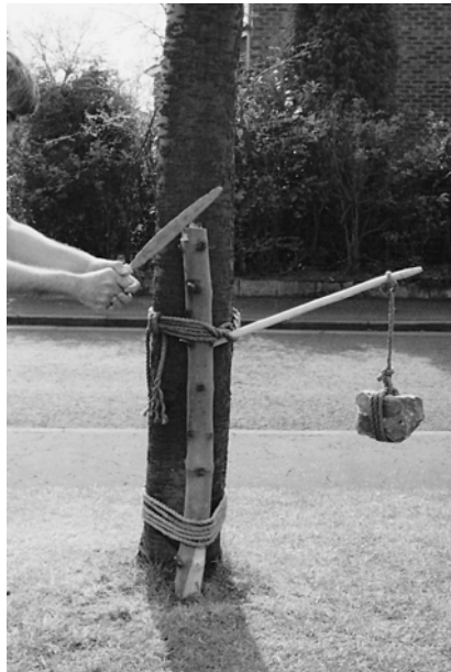
Illustration 2.59 Utiliser une scie à deux mains pendant que le bois reste solidement attaché à un poteau enfoui dans le sol
