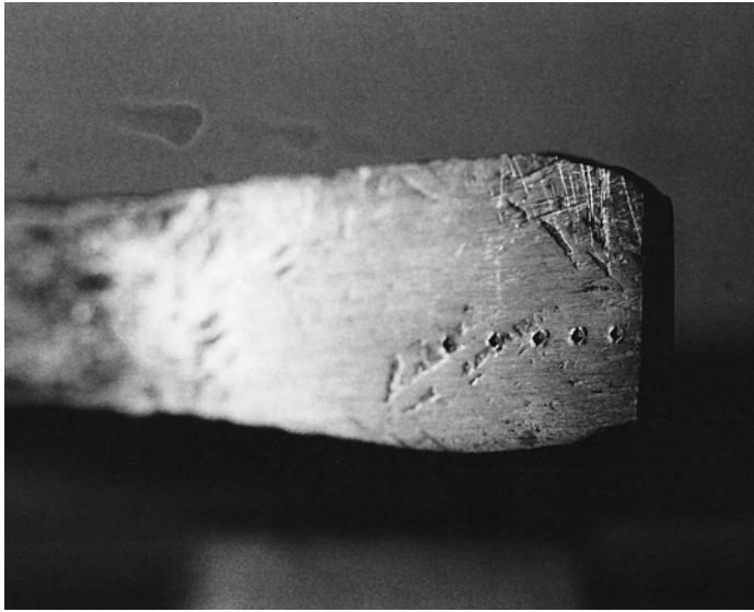
Illustration 2.53 Marques de test de dureté sur le cône d'un ciseau en cuivre
