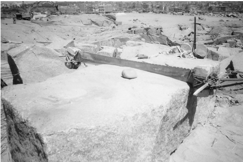
Figure 6.3 Une scie à pierre devait être légèrement plus longue que la largeur d'un bloc de pierre, pour permettre son mouvement alternatif
