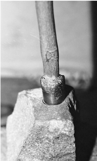
Illustration 4.9 Gros plan d'un foret tubulaire en cuivre, engagé dans le trou de forage. Notez que le trou est légèrement surcoupé en raison des forces latérales imposées lors de l'action de forage
