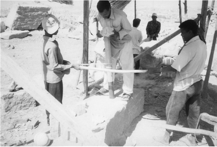
Figure 4.21 Au premier plan, l'équipe de trois ouvriers fore un bloc de rose granit avec un tube de cuivre de 8 cm de diamètre. En arrière-plan, deux scieurs actionnent la scie à cuivre à lame plate
