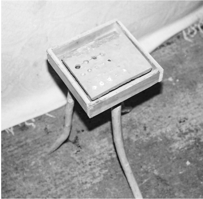
Illustration 8.17. un des blocs de boue d'essai, avec des morceaux de pierre d'essai fermement maintenus à l'intérieur
