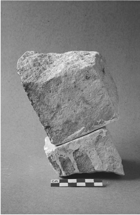
Illustration 7.18. Le test de glissement lubrifié à l'aide des blocs de calcaire préparés
