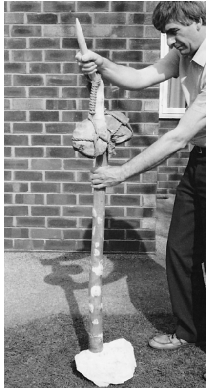
Illustration 5.22 Une torsion dans le sens inverse des aiguilles d'une montre d'un grand arbre de forage
