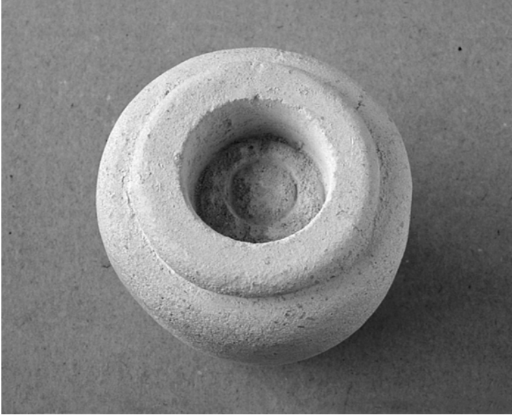
Illustration 5.32 Le noyau tubulaire est maintenant retiré
