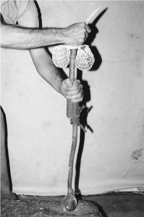
Figure 5.19 Un TRTD, équipé d'un arbre fourchu, entraînant un foreur de pierre
