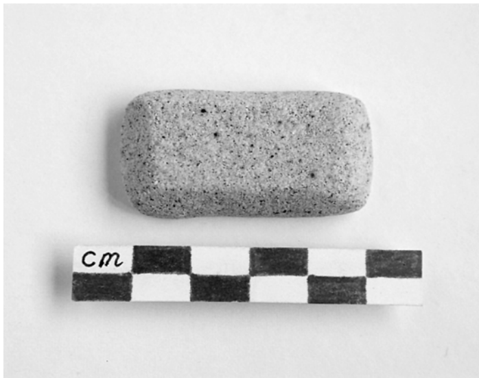
Illustration 9.2 Un noyau d'essai, fabriqué à partir de poudre dérivée de calcaire dur
