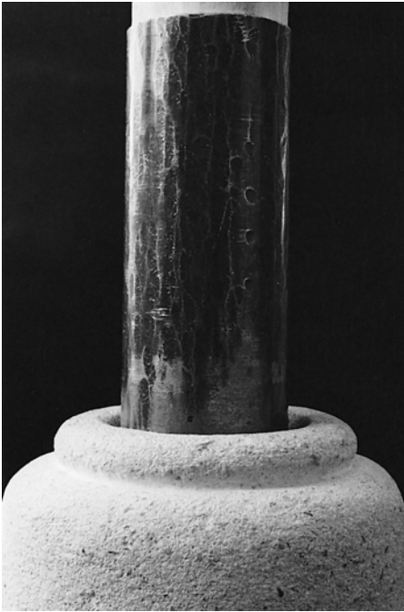
Illustration 5.29 Perçage du vase avec un tube de cuivre de 4 cm de diamètre
