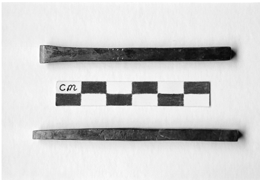
Figure 2.3. Les formes du ciseau plat (en haut) et du ciseau à coupe transversale (en bas) se rétrécissent
