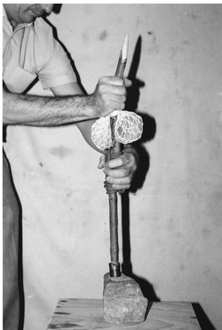
Figure 5.16 Un TRTD reconstruit, lesté de deux pierres, entraînant une perceuse tubulaire en cuivre
