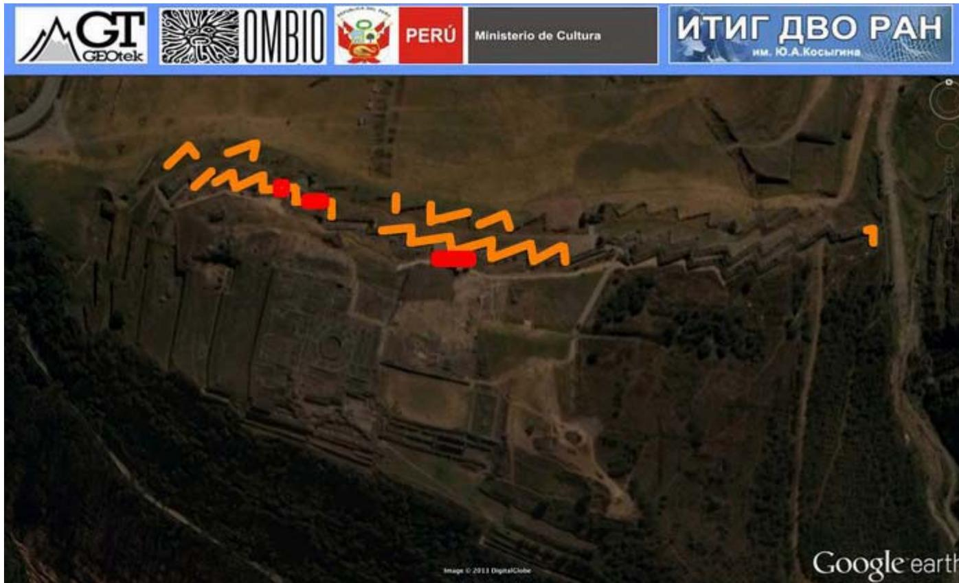
Les écarts importants entre les blocs sont marqués en orange, les lieux d'effondrements sont marqués en rouge. Au cours de la recherche, 4 profils ont été mesurés sur les niveaux principaux du complexe. Pour un maximum de détails, les mesures ont été prises avec un pas minimum de 10 cm (la précision du pas était assurée par un ruban à mesurer).
