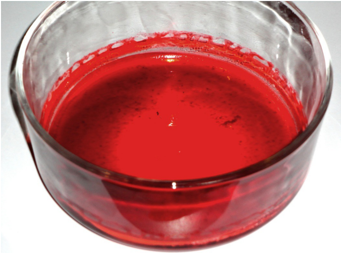
Essence concrète de fraise collée aux parois et au fond de l'évaporateur avec ventilation forcée.
