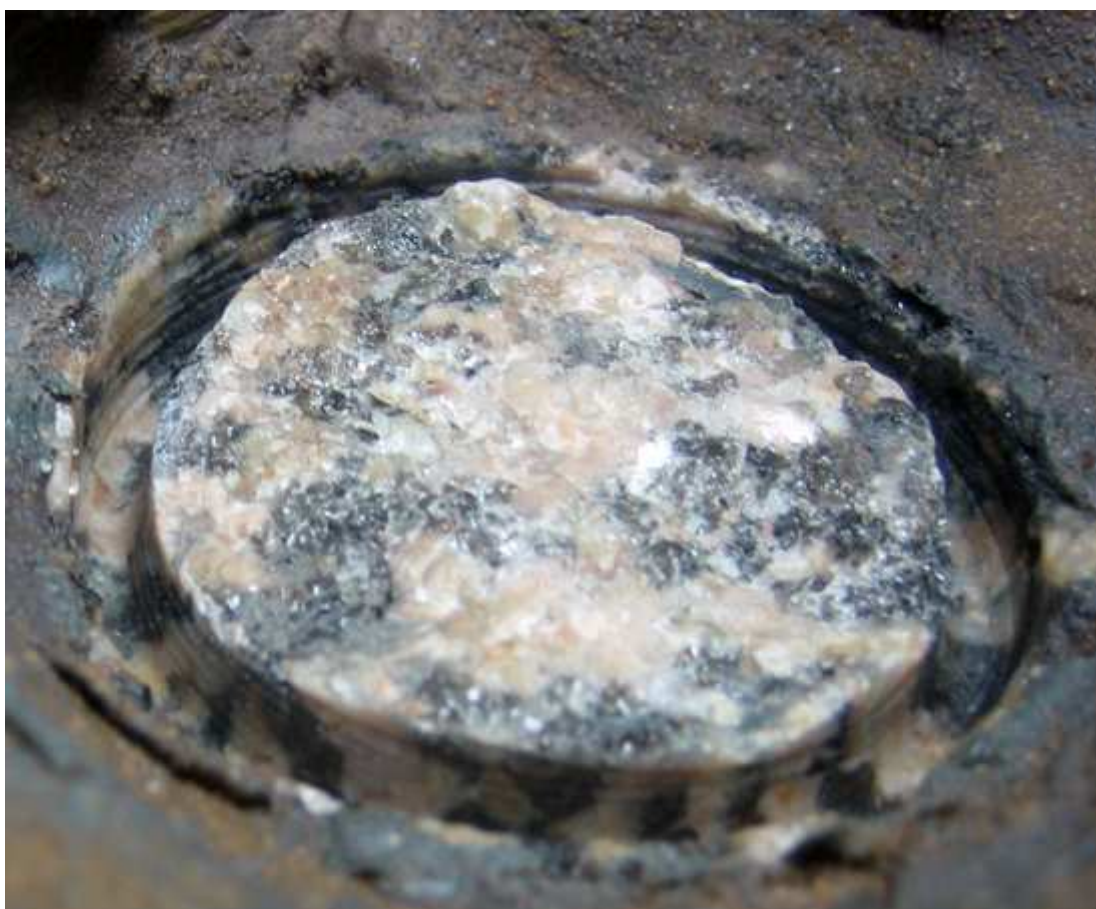
Рис. 8. Применение песка сразу привело к образованию четких и глубоких канавок.
