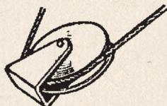
Fig. 169. — Poulie mal orientée.
