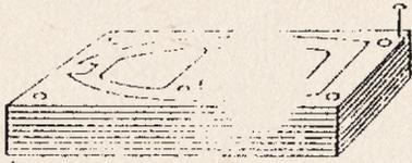
Fig. 69. -- Bloc de nervures en contreplaqué
