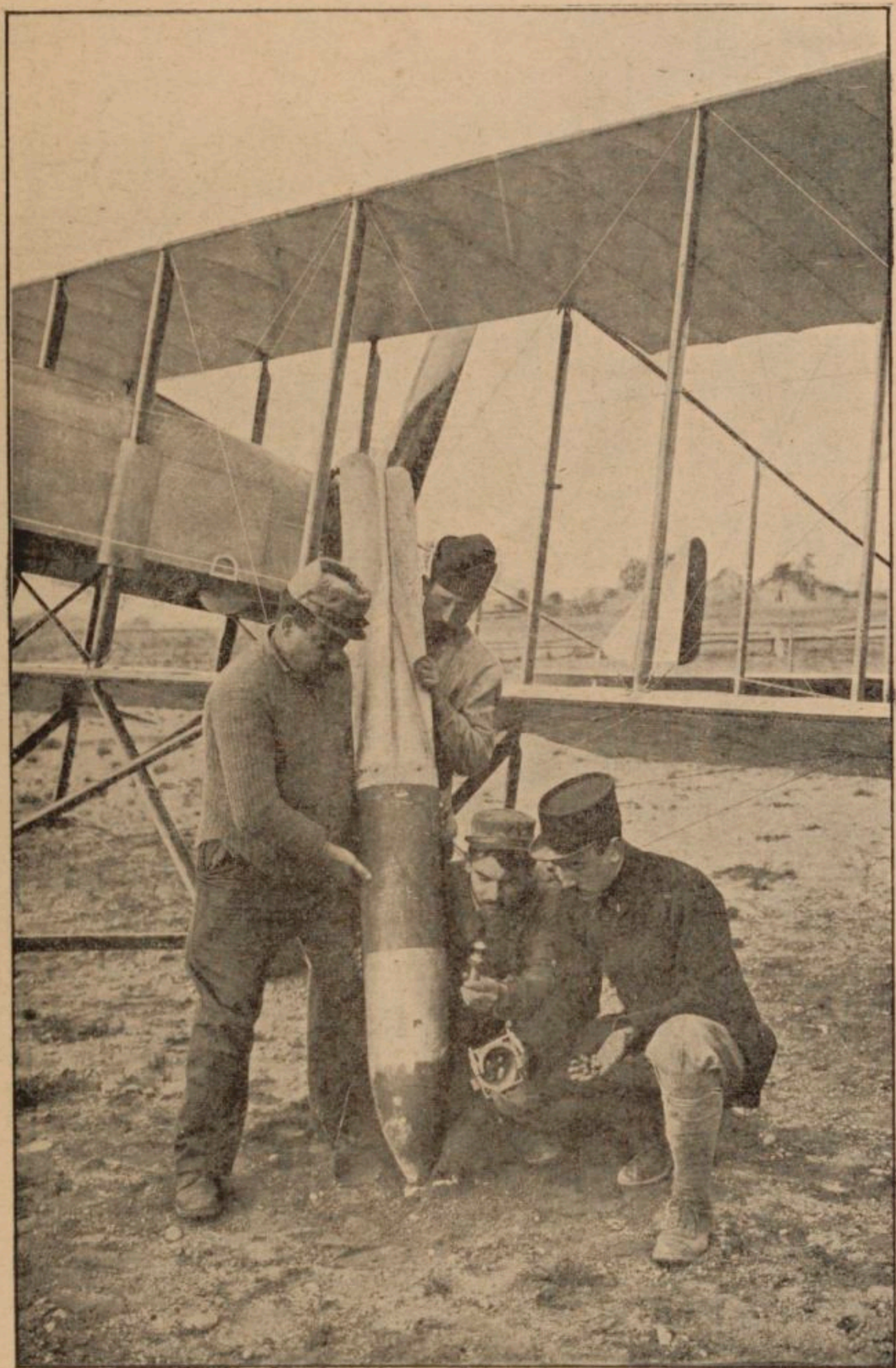
LA MISE EN ÉTAT D'UNE TORPILLE.
