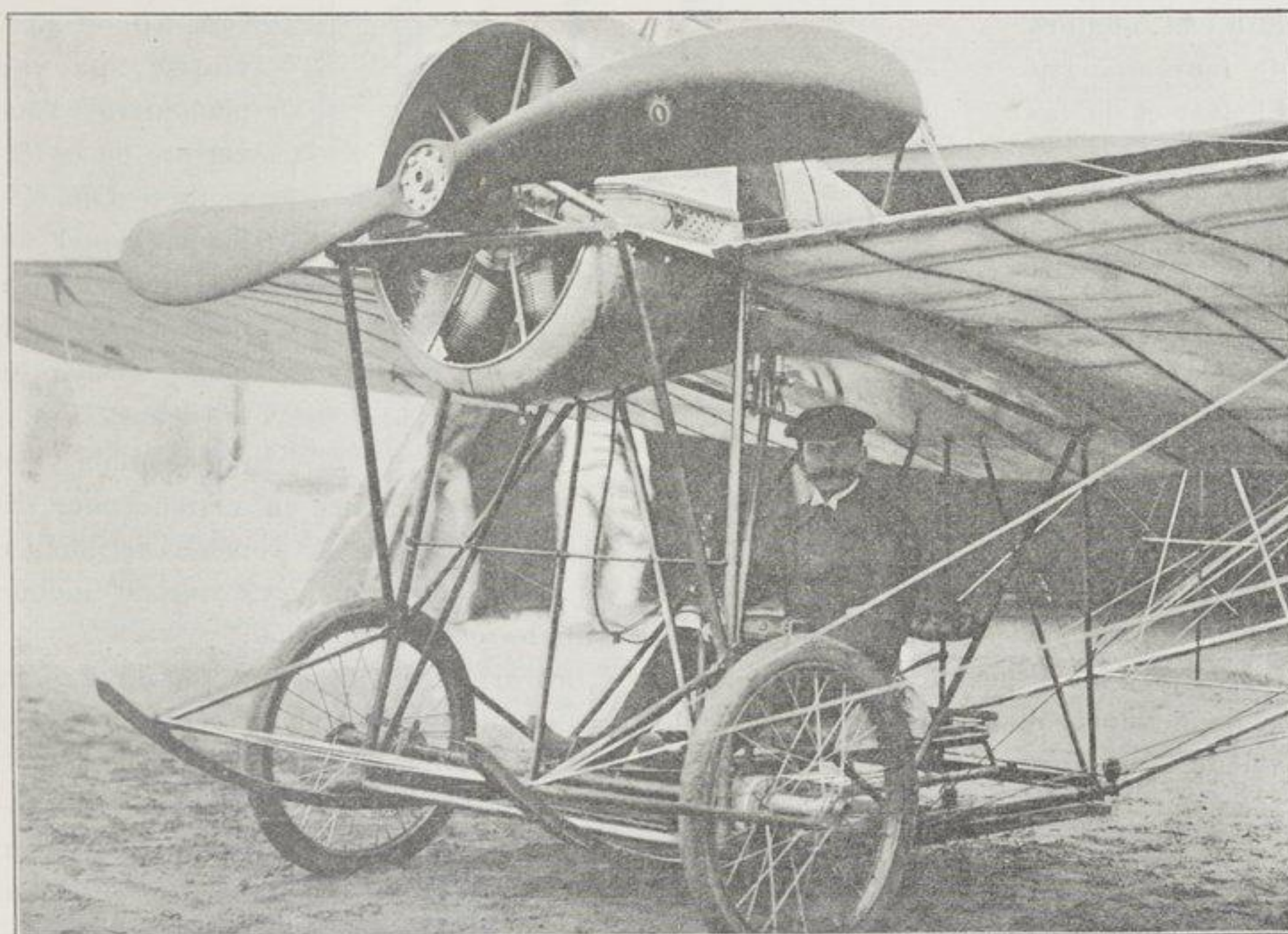
Fig. 487. — Hélice et dispositif d'atterrissage du monoplan Train (1911).
