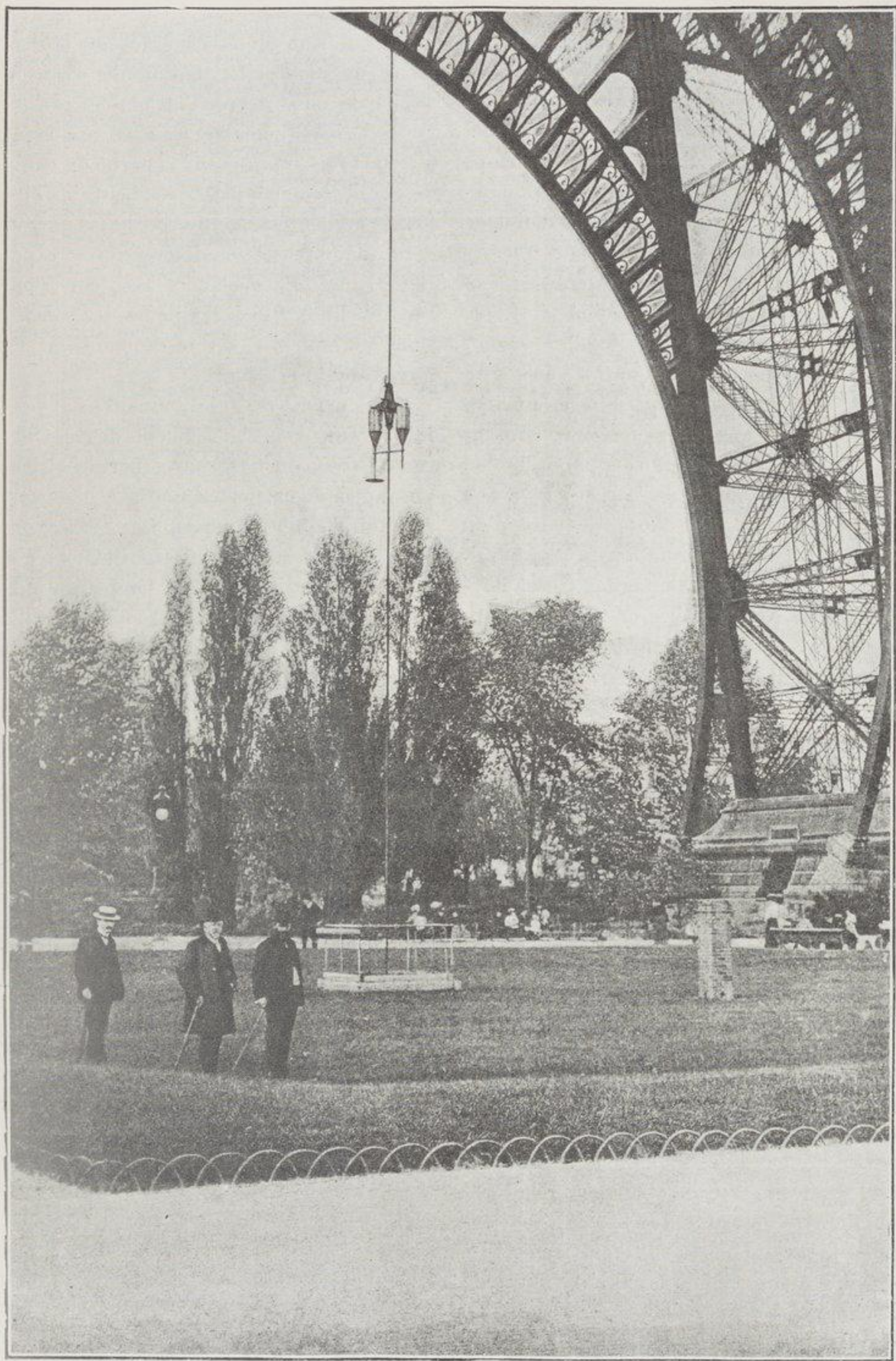
Fig. 400. — Disposition, à la tour de 300 mètres, de l'appareil de M. G. Eiffel pour mesurer la résistance de l'air.
