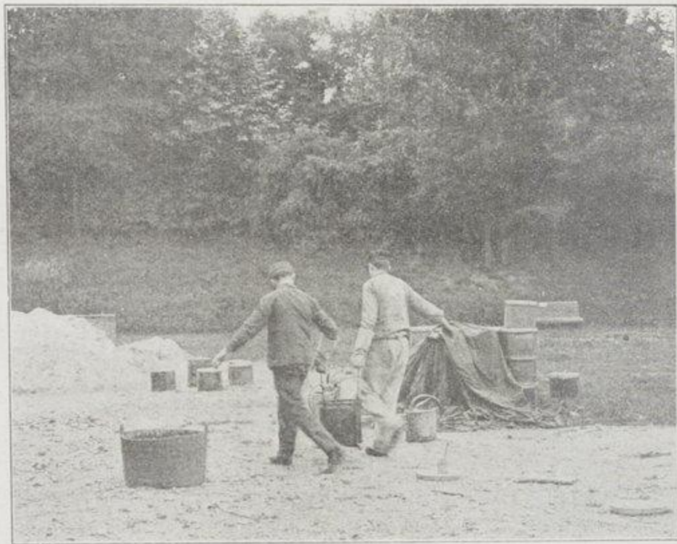
Fig. 196. — Le transport des cartouches brûlées : chacun des hommes porte un gant d'amiante pour se protéger contre la chaleur.
