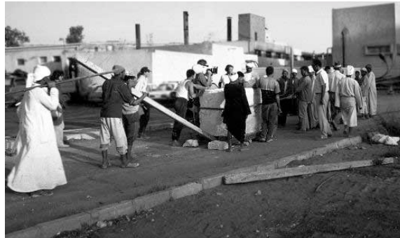
Figure 80: l'expérience faite par les ouvriers de Nova pour tirer une grosse pierre sur des rouleaux ne fût possible que sur une surface plate et dure, comme la route goudronnée moderne. Cela ne marche pas sur le sable (1991).
