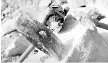
Figure 78 (au-dessus): les ouvriers de Nova utilisèrent des outils en acier moderne (à gauche et à droite, et pas du tout l'imitation d'outil en pierre de l'Ancien Empire (au centre) (1991).
