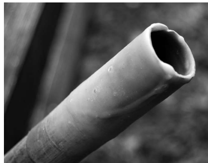
Figure 10. Foret tubulaire expérimental en cuivre enduit de cire.
