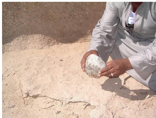
Boule de dolérite utilisée après l'attaque au feu pour dégager la partie fragilisée de la roche.
