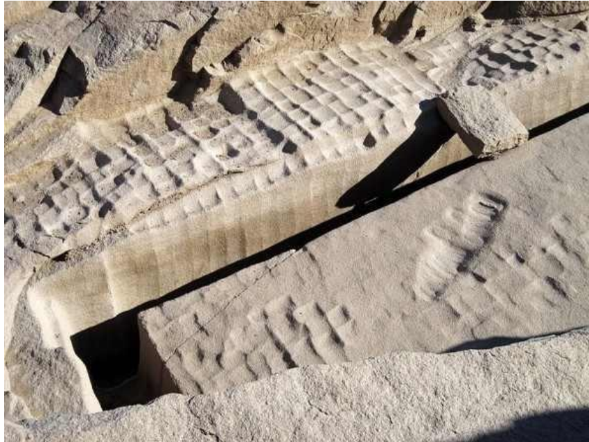
Cupules en marches d'escalier montrant la technique d'attaque au feu pour la décohérence des minéraux de la roche.
