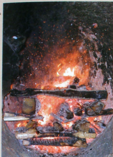
1. Cette image saisit l'instant précis où la paroi chauffée à 700 °C est étonnée : de fines écailles sont violemment projetées loin du front de taille, bousculant au passage des braises (expérience 2003/37, à 40 mn de l'allumage).
